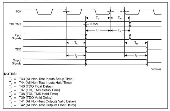
**Figure 18. Test Reset Timings**
