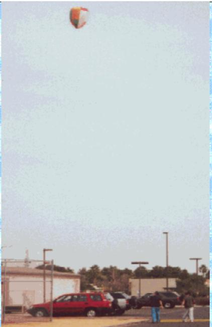
Durante el primer lanzamiento de nuestro globo, la temperatura del aire en el interior fue de 73° C y en el exterior era de 30° C. El tiempo de vuelo de nuestro globo fue de 2' 4'' . La siguiente vez que lanzamos nuestro globo, la temperatura interna era de 80° C y la exterior de 30° C. Esta vez nuestro tiempo de vuelo fue de 2' 44'' . ¡Impresionante!
