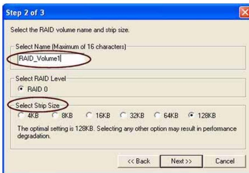
RAID Volume の初期設定の名前は RAID\_Volume1 です。次に RAID 0 アレイのストライプ・サイズを選択します。設定できるサイズは 8KB ~ 128KB (8KB ステップ) です。ストライプ・サイズは予定しているディスクの用途に応じて選択します。以下に推奨されるストライプ・サイズの例を示します。初期設定のストライプ・サイズは 64KB です。
