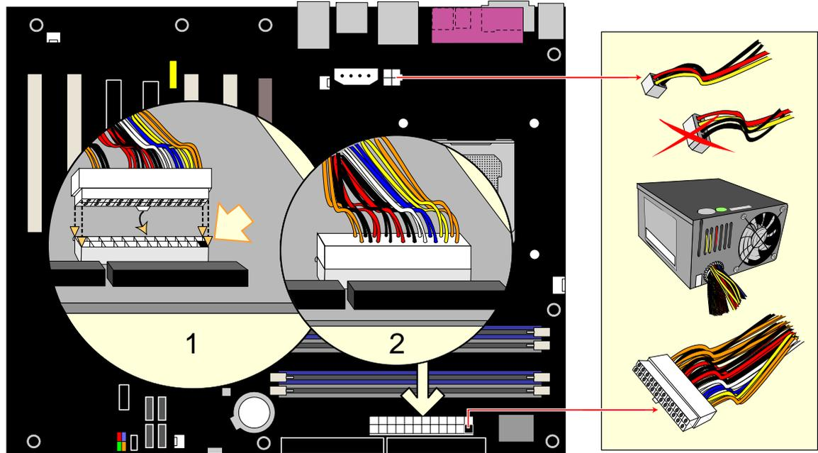
図 28. 2x12 電源ケーブルの接続
