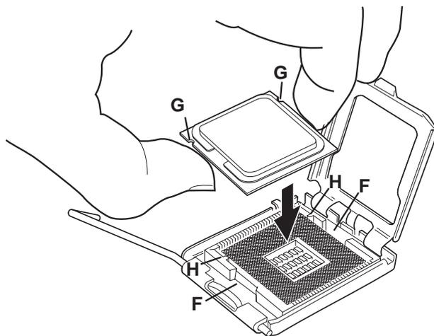
図 10. プロセッサを取り付ける
