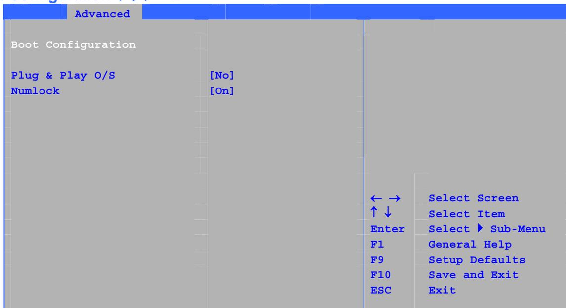
表 18 に示すサブメニューは、Plug & Play オプションおよび Numlock キーの電源投入時の状態を設定するために使用します。
