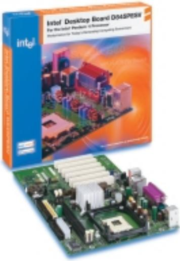
インテル® デスクトップ・ボード D845PESV は、デスクトップ・ボード・テクノロジーにおけるインテルの最新の開発成果を組み込み、インテル® Pentium® 4 プロセッサ向けプラットフォームのポートフォリオの幅を広げる製品です。このデスクトップ・ボードは、インテル® 845PE チップセットを搭載しており、DDR333<sup>1</sup> SDRAM メモリ・テクノロジーに対応し、自動ファン制御機能によってシステムの騒音を軽減します。
