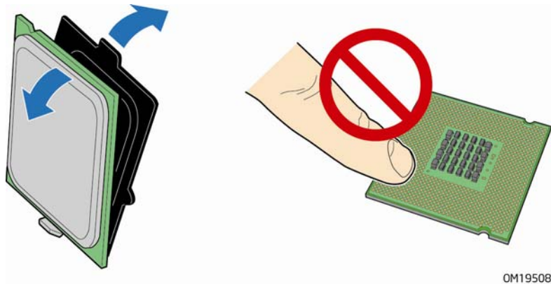
图 9. 从处理器保护罩中取出处理器
