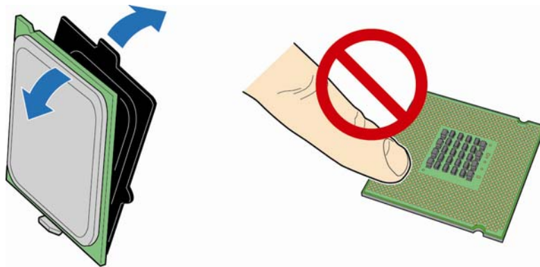
图 9. 从处理器保护罩中取出处理器
