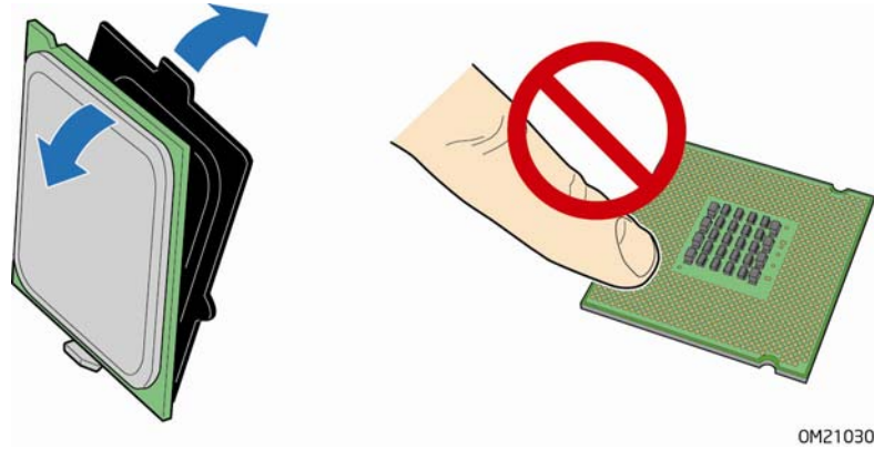
图 9. 从处理器保护罩中取出处理器
