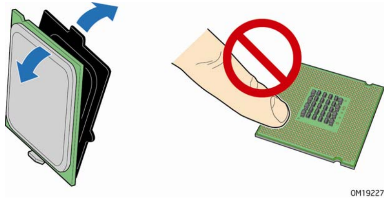
图 9. 从处理器保护罩中取出处理器
