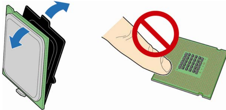
图 9. 从处理器保护罩中取出处理器
