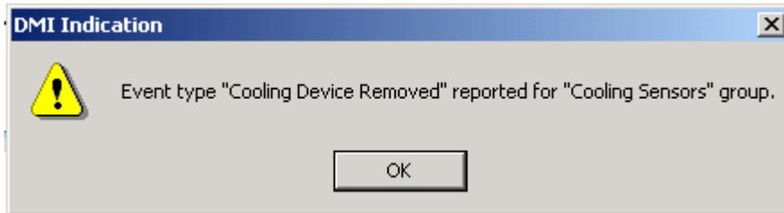
PIC aktualisiert zudem die PIC-Schnittstelle, so dass der Zustand des entfernten Lüfters nicht mehr geprüft wird. Wenn ein System z. B. fünf Lüfter unterstützt und Lüfter Nr. 3 entfernt wurde, zeigt PIC den Zustand von Lüfter 1, 2, 4 und 5 ohne Angabe zu Lüfter 3 an.
