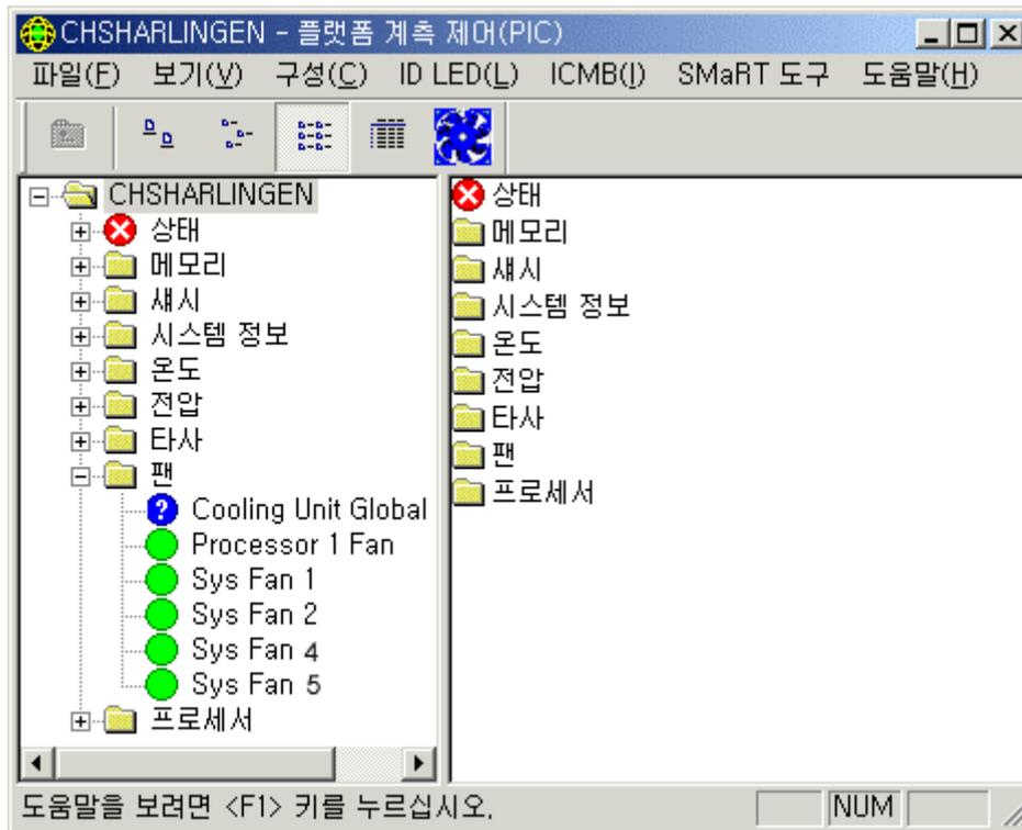
팬이 설치 또는 재설치되면 PIC 는 경고를 관리 콘솔에 보내고 다음과 같이 PIC 인터페이스를 새로 고쳐 새로 설치된 팬을 보고합니다
