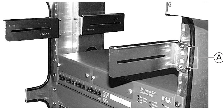
图 14. 安装到机架左后侧的 FR/RL 支架
