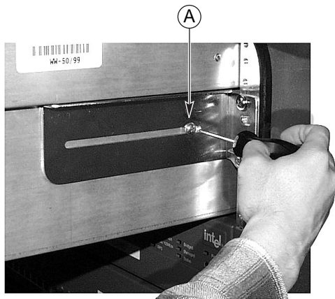
图 16. 使用标记为“A”的一个螺丝将机箱固定到支架上
