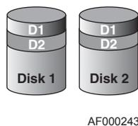
Abbildung 40. RAID 1 – Festplattenspiegelung/-duplizierung
