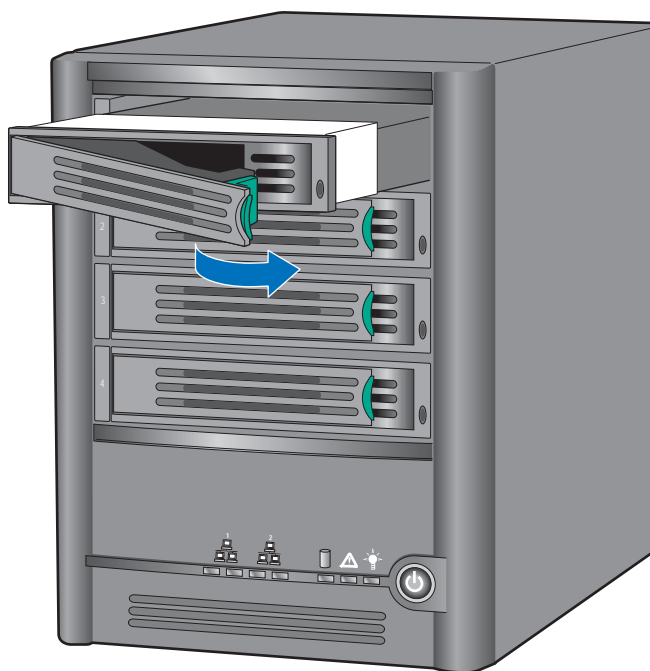
Рисунок 10. Обратная установка корзины в корпус системы хранения
