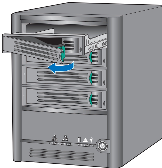
Рисунок 16. Извлечение корзины из корпуса системы хранения
