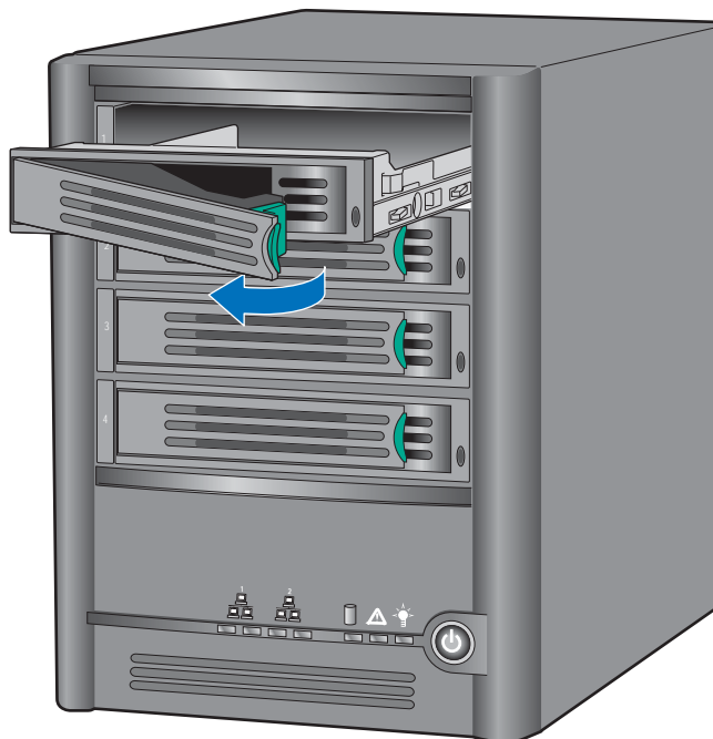
Рисунок 4. Извлечение корзины из корпуса системы хранения
