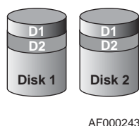
Рисунок 40. RAID 1 – зеркалирование дисков/дублирование дисков
