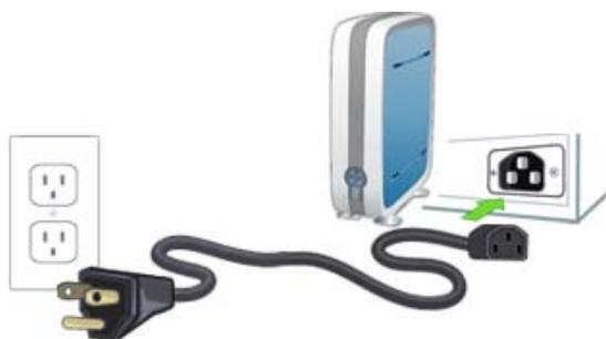
3. Нажмите кнопку включения питания, расположенную с передней стороны системы хранения, и, прежде чем продолжить, дождитесь зеленого свечения светодиодов.
