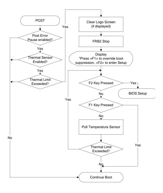
Figure 27. Thermal Sensor
