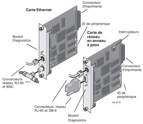
Exemples d'insertion, dans les imprimantes, de cartes de serveurs d'impression NetportExpress PRO. Votre imprimante peut être différente de celle illustrée. Assurez-vous que le connecteur d'imprimante de la carte est complètement inséré dans la fente de connecteur de l'imprimante.
