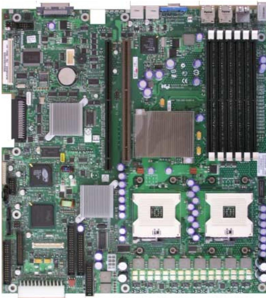
Рисунок 41. Схема системной платы SE7520JR2
