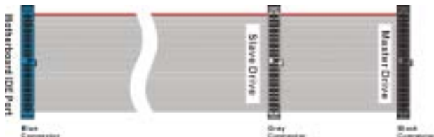
図 2-8. Ultra DMA 66 リボンケーブルの略図
