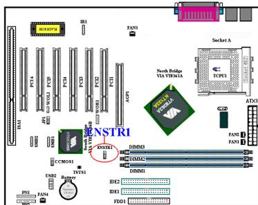
Ce cavalier vous permet d'activer ou de désactiver la fonction Suspend To RAM (STR). Avec les pins 1 et 2 fermés, cette fonction est activée (par défaut), avec les pins 2 et 3 fermés, elle est désactivée. Veuillez vous référer à l'item BIOS ACPI Suspend Type pour une configuration correcte.
