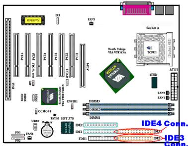
En addition des IDE1 et IDE2 qui supportent l'UDMA 33/66, la KT7-RAID inclut le support pour l'UDMA 100 à travers son contrôleur intégré IDE HPT370. Les connecteurs IDE3 et IDE4, au total, supportent jusqu'à 4 périphériques UDMA 33/66/100.
