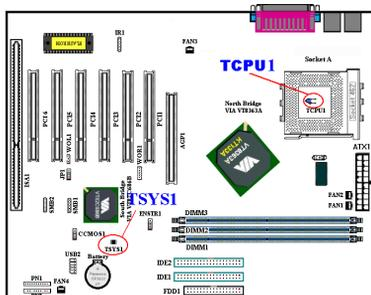
Le TCPUI est utilisé pour détecter la température du CPU. Le TSY1 est quant à elle utilisé pour capter celle de l'environnement ambiant. Vous pouvez voir les données relevées par ces sondes dans le BIOS ou l'utilitaire de surveillance VIA.
