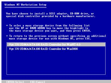
**Étape 5:** Utilisez les touches fléchées HAUT et BAS pour positionner la surbrillance sur le périphérique de stockage de masse désiré et appuyez sur <ENTREE> pour continuer l'installation.
