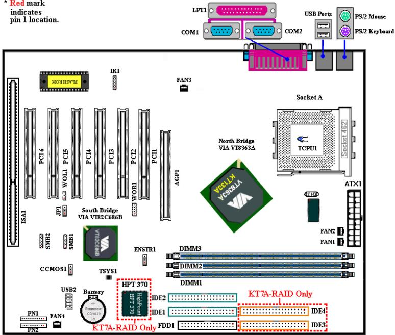
Figure 1-2. Emplacement des composants sur la KT7A/KT7A-RAID
