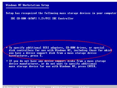
**Etape 2:** Le programme d'installation affichera un message à propos de l'installation de périphériques de masse durant l'installation de NT4.0. Veuillez appuyer sur "S" pour installer les pilotes HPT370.
