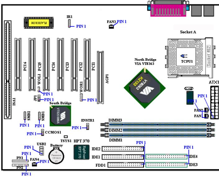
Figure 2-7B. Tous les Connecteurs et Switches de la KT7-RAID
