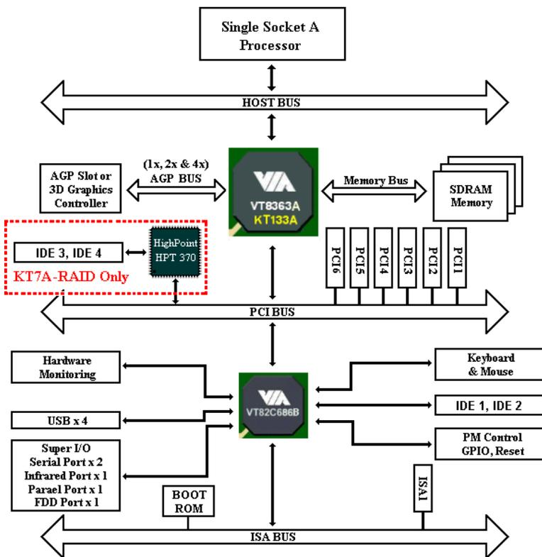
Figure 1-4. Diagramme Système de la KT7A/KT7A-RAID
