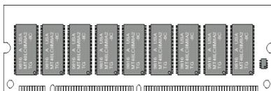
**Figure 2-5 PC66/100/133 Module et Composants**
