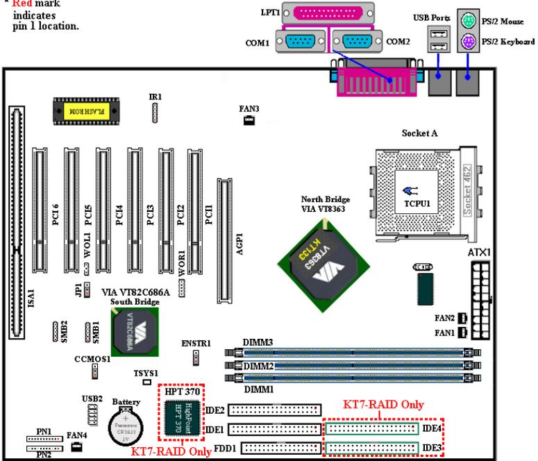
Figure 1-1. Emplacement des composants sur la KT7/KT7-RAID
