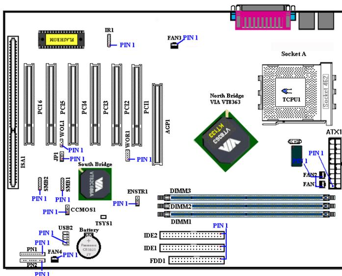
Figure 2-7A. Tous les connecteurs et Switches de la KT7
