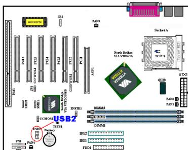
Ce connecteur sert à y brancher des ports USB supplémentels. Vous pouvez utiliser une nappe d'expansion USB (optionnel) pour obtenir ainsi deux Plugs USB supplémentels. Ces Plugs peuvent être fixés ensuite à l'arrière de votre boîtier.
