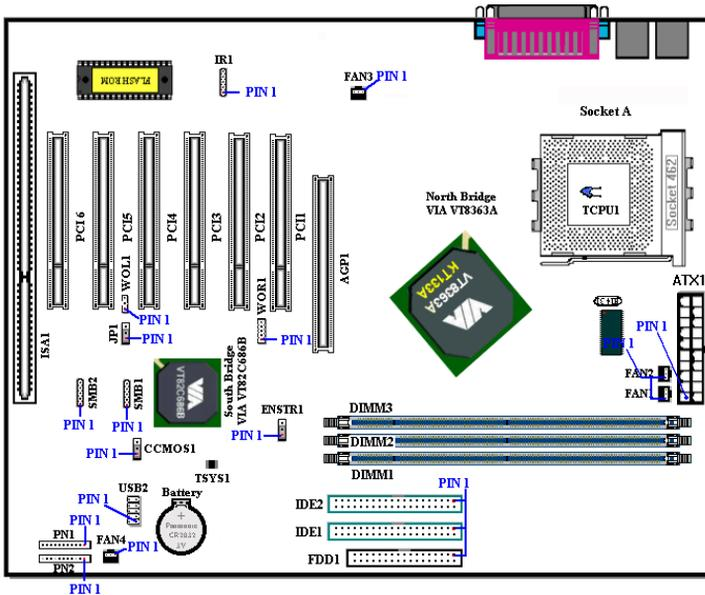
Figure 2-7C. Tous les Connecteurs et Switches de la KT7A
