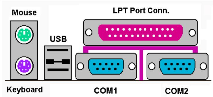
**Figure 2-11. Connecteurs du panneau arrière de la KT7/KT7-RAID/KT7A/KT7A-RAID**
