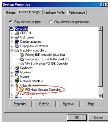
**Etape 1:** Après que le système d'exploitation Windows<sup>®</sup> 9x a été installé et redémarré avec succès, allez dans le **“Panneau de Configuration”** → **“Propriétés Système”** → **“Gestionnaire de Périphériques”**. Vous pouvez voir que les pilotes ne sont pas encore installés, et qu'il y a un périphérique **“? PCI Mass Storage Controller”** sous **“Autres Périphériques”**
