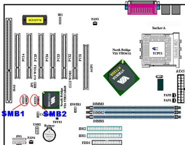
Ce connecteur est réservé pour le bus de gestion du système (SMBus). Le SMBus est une implémentation spécifique du bus I<sup>2</sup>C. Le I<sup>2</sup>C est un bus multi-master, ce qui signifie que plusieurs chips peuvent être connectés au même bus et chacun d'entre eux peut agir en tant que master en initiant un transfert de données. Si plus d'un master essaient de contrôler simultanément le bus, une procédure d'arbitrage décidera alors
