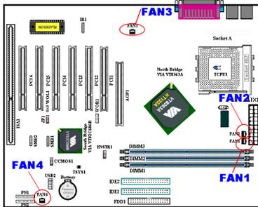
Branchez le connecteur de votre ventilateur CPU sur le connecteur marqué FAN1 ou FAN2 (ou les deux si vous utilisez un système double ventilateur), celui du ventilateur boîtier sur le FAN4 et enfin celui de l'alimentation sur le FAN3.
