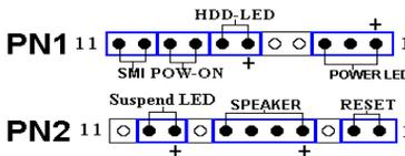
Figure 2-9. Définitions des pins des PN1 et PN2
