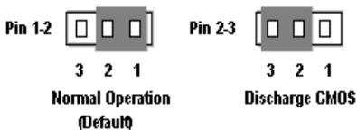
Figure 2-8. Positions du CCMOS1
