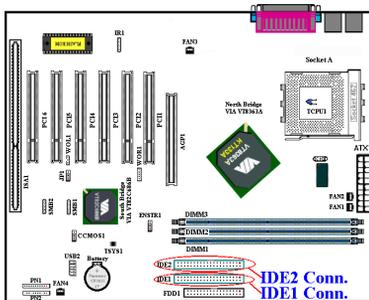
Une nappe IDE possède 40 fils et deux connecteurs permettant le branchement de deux disques durs IDE. Après avoir connecté une extrémité sur l’IDE1 (ou IDE2), connectez les deux connecteurs restants sur le disque dur IDE (ou lecteur de CD-ROM, LS-120, etc.).
