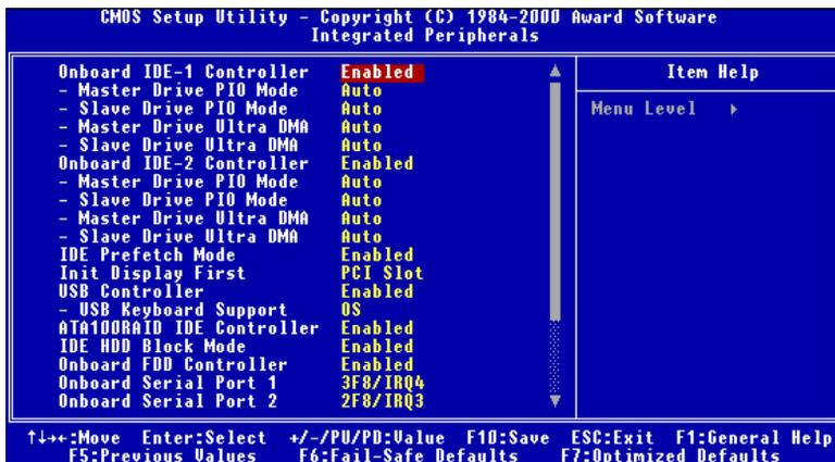
Figure 3-6C. Partie supérieure de l'Integrated Peripherals Menu (KT7(A)-RAID)
