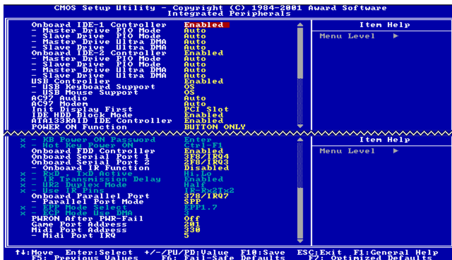
図 3-7. Integrated Peripherals Menu スクリーン
