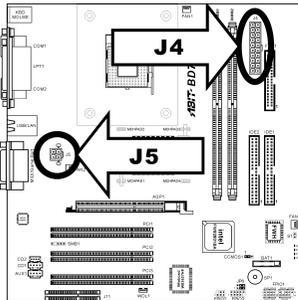
Le pentium 4 requiert une alimentation différente de celles généralement utilisée. C'est un nouveau type d'alimentation ATX12V en 300W, une capacité minimale de 20A +5VDC pour supporter les charges les plus lourdes et 720mA +5VSB au moins pour supporter la fonction Wake-On-LAN.
