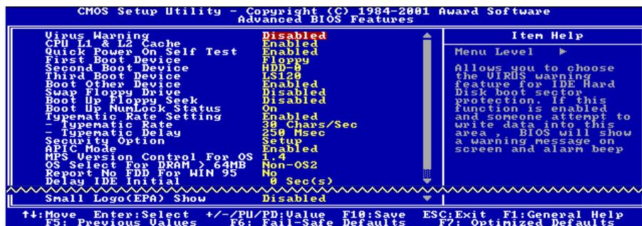
Figure 3-4. Partie supérieure de l'Advanced BIOS Feature
