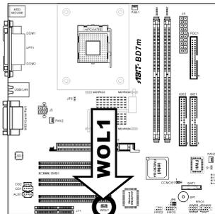
Ce connecteur sert à brancher la sortie Wake-On-LAN de la carte réseau pour permettre de réveil du système à travers un réseau local.
