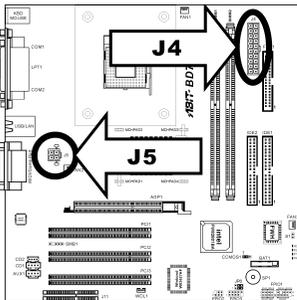
Der Pentium 4 erfordert ein anderes Netzteil als üblich. Es ist ein neu entworfenes ATX12V-Netzteil mit 300W, mindestens 20A +5VDC-Kapazität für stark belastete Systeme und mindestens 720mA +5VSB zur Unterstützung für die Wake-On-LAN-Funktion.
