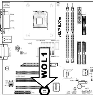
Dies schließt den Wake-On-LAN-Ausgang einer LAN-Karte an, um Ihren Computer durch ein Local Area Network aufzuwecken zu lassen.
