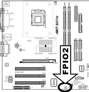
Über diesen Header können Sie ein optionales IR-Gerät ans Gehäuse anschließen. Dieses Motherboard unterstützt Standard IR-Transferraten.
