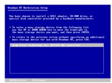
ステップ 5: 上下矢印キーを使って大容量ストレージデバイスをハイライトし、<ENTER>キーを押します。
