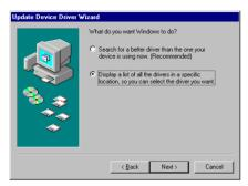
**Step 4:** [Display a list of all the drivers in a specific location...] をクリックして、[Next>] をクリックします。
