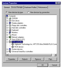
ステップ 11: [コントロールパネル] → [システムのプロパティ] → [デバイスマネージャ] を選択します。[SCSI and RAID controllers] の項目の下に、ドライバが表示されているはずです。
