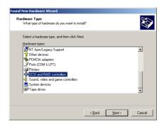
**ステップ 3:** [SCSI and RAID controllers] を選択して、「次へ」をクリックします。
