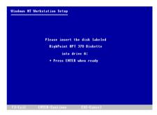
ステップ 7: ハードディスクを設定してインストレーションパスを指定したら、Windows NT のセットアップが hpt 370 IDE RAID コントローラカードのドライバディスクを A ドライブに挿入するように要求しますので、ディスクを挿入して<ENTER>キーを押してください。
