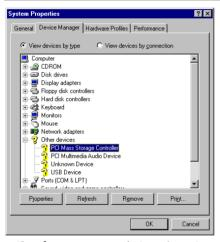
ステップ1: Windows 9xOS をインストールして リブートした後、[コントロールパネル]→[シ ステムのプロパティ]→[デバイスマネージャ] を選択します。ドライバがインストールされて いない場合は、[その他のデバイス] に [? PCI Mass Storage Controller] というデバイスが表示 されているはずです。
