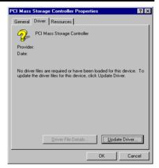
ステップ 2: [? PCI Mass Storage Controller] を 右クリックし、[ドライバ] タブをクリックし ます。[ドライバの更新] をクリックして次の ステップへ進んでください。
