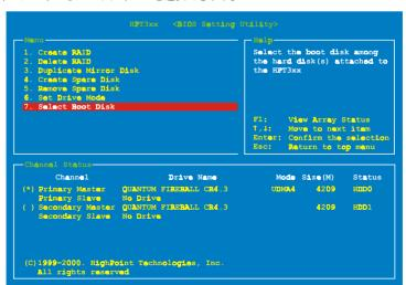
上下矢印キーを使ってメニューオプションから "Select Boot Disk"を選択し、<Enter>を押します。 Channel Status で、ブートディスクとして設定したいチャネルを選択し、<Enter>キーを押します。カッコの中に星印がついたものは既に選択されたチャネルです。
