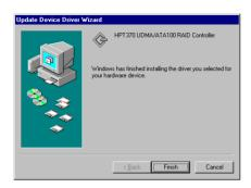
ステップ 10: ドライバのインストールが完了 しました。[完了] をクリックしてインストー ルを終了します。
