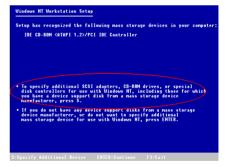
ステップ 2: Windows NT 4.0 をインストールしているときに、セットアッププログラムが大容量ストレージデバイスのインストールについてのメッセージを表示するはずです(上図)。その後で S キーを押して hpt370 ドライバをインストールしてください。
