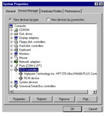
ステップ 11: システムをリブートした後、[コントロールパネル]→[システムのプロパティ]→[デバイスマネージャ]を選択します。[SCSI controllers]の項目にドライバが表示されているはずです。
