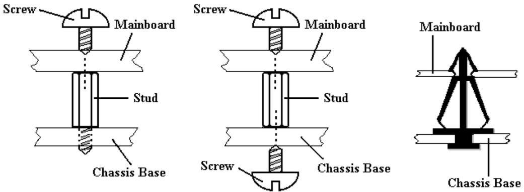
**Note:** Si la carte mère a des trous de montage qui ne s'alignent pas avec ceux de la base sur le châssis et qu'il n'y a pas de rainures pour insérer des spacers, ne vous inquiétez pas, vous pouvez toujours utiliser des spacers avec les trous de montage. Coupez simplement la partie « bouton » du spacer (attention à vos mains, le spacer peut être difficile à couper). De cette manière vous pouvez toujours fixer la carte mère à sa base sans vous soucier des courts-circuits.
