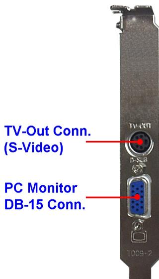
図 2-3. SILURO™ GF256 GTS グラフィックアクセラレータカードのプレートレイアウト
