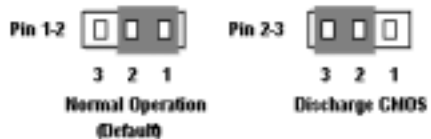
Abb. 2-8. CCMOS1 Brückeneinstellung
