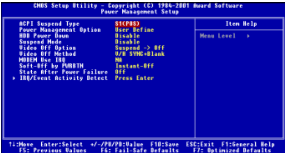
図 3-7A. Power Management Setup のメインメニュー
