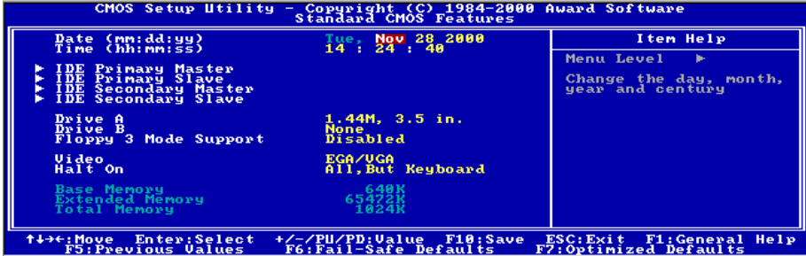
圖 3-3. Standard CMOS 設定選單畫面
