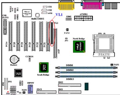
Ce connecteur est utilisé pour insérer une carte additionnelle pour permettre la VGA intégrée d'être utilisée comme sortie TV-Out ou FPD.
