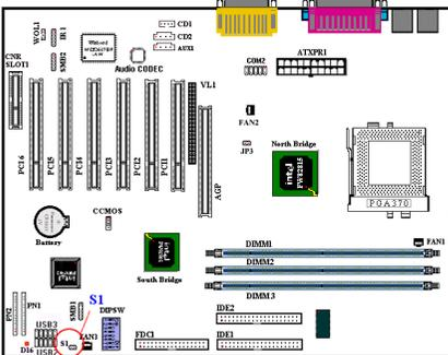
Ce connecteur sert à brancher un système de détection d'intrusion châssis.
