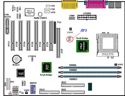
Ce connecteur sert à connecter la sonde thermique utilisée pour la température environnante du système. Il peut aussi être appelé un capteur de température système. Vous pouvez brancher l'extrémité de la sonde thermique (optionnel) au connecteur JP3, puis ensuite coller l'autre bout sur le dissipateur de chaleur CPU. En général, vous devez le coller le plus près possible de la puce même du CPU et éviter de le placer trop près du ventilateur CPU.
