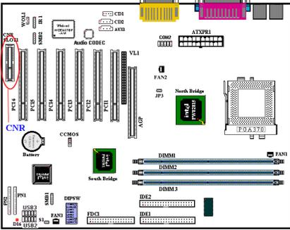
Ce slot est utilisé pour une carte CNR optionnel dont le principal objectif est de permettre la réduction des coûts d'implémentation des fonctionnalités couramment utilisées dans les "Connected PC" ainsi que de résoudre les actuelles limitations fonctionnelles des sous-systèmes audio, modem et LAN.
