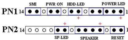
Figure 2-7. définitions des pins du PN1 et PN2
