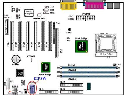
Ces commutateurs vous permettent d'ajuster manuellement la vitesse du FSB.
