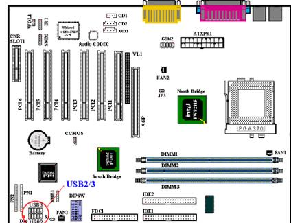
Ces connecteurs servent à brancher des plugs USB additionnels. Vous pouvez pour cela utiliser le câble d'expansion USB spécial. Ce
