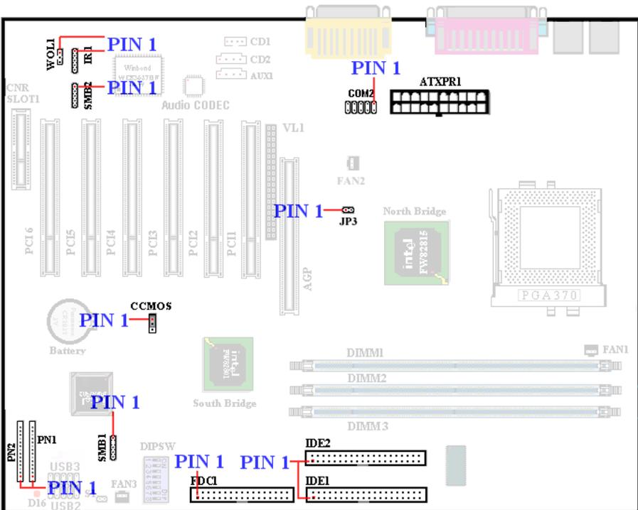
Figure 2-5. Dispositions de tous les connecteurs et broches sur la SE6
