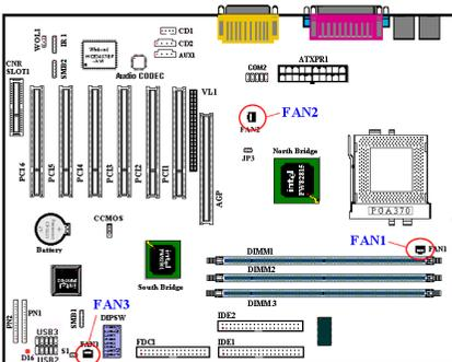
Connectez le ventilateur de votre CPU sur le FAN1, celui de votre boîtier sur le FAN3 et celui de votre alimentation sur le FAN2.
