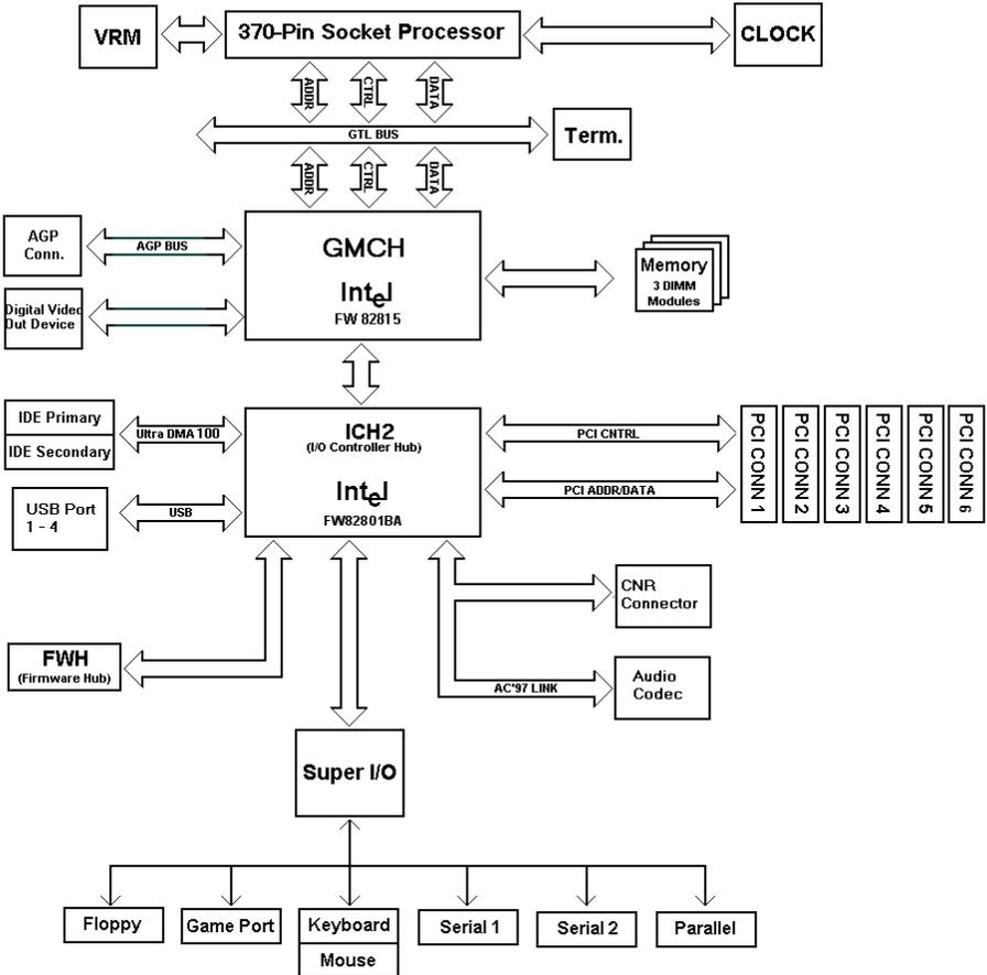
Figure 1-2. diagramme Système du chipset INTEL 815E
