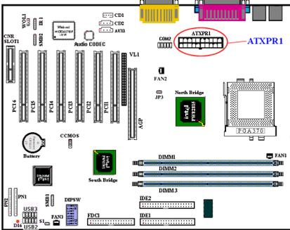
Connectez le connecteur d'alimentation de votre alimentation ATX ici. Des détrompeurs sont présents pour vous guider dans le sens de connexion. Enfoncez fermement votre connecteur jusqu'au bout dans l'ATXPRI, vous assurant ainsi d'une bonne connexion.
