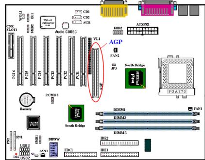
Cette fonction est utilisée pour l’installation un AGP Inline Memory Module (option modèle RM-04). Ceci est une fonctionnalité qui permet d’améliorer les performances 3D de la VGA intégré.
