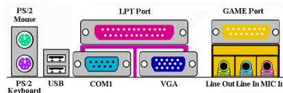
**Figure 2-9. Disposition des connecteurs arrière de la SE6**
