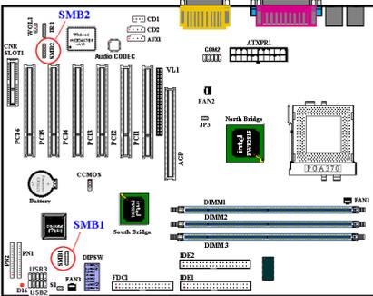
Ce connecteur est réservé pour le System Management Bus (SM bus). Le Sm Bus est une implémentation spécifique du bus I<sup>2</sup>C. I<sup>2</sup>C est un bus multi-Master, cela signifie que plusieurs puces peuvent être connectées au même bus et que chacun d'entre eux peut agir en tant que
