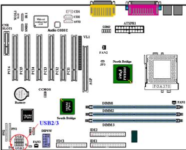
Diese Header dienen dem Anschluß zusätzlicher USB-Schnittstellenstecker. Sie können ein spezielles USB-Schnittstellenerweiterungskabel verwenden. Dadurch verfügen Sie über zwei zusätzliche USB-Stecker. Die Anschlüsse für die USB-Stecker befinden sich auf der Rückseite.
