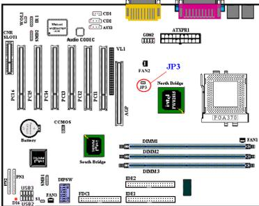
Dieser Header ist ein Thermistoranschluss zum Erkennen der Systemtemperatur. Man kann es auch eine Systemtemperaturerkennung nennen. Sie können ein Ende des zweiadrigen Thermalkabels (optional) an den JP3-Header anschließen und dann das andere Ende des Kabels mit dem Kühlblech der CPU verbinden. Im Allgemeinen sollte die Lage des Thermistors so nahe am CPU-Chipsatz wie möglich liegen, und nicht zu nah am CPU-Lüfter.
