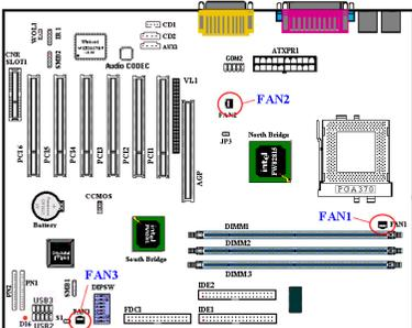
Den Anschluß vom einzelnen CPU-Ventilator an den mit FAN1 bezeichneten Header anschließen. Dann den Anschluß von der Chassis an den Header FAN2(oder FAN3) anschließen.
