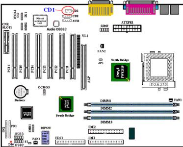
Dieser Header dient dem Anschluss des Audiokabels des internen CD-ROM-Laufwerks. Überprüfen Sie das Audiokabel des CD-ROM-Laufwerks und stellen fest, über welchen Anschluss Sie verfügen. Verbinden Sie den Anschluss dann mit diesem Header.
