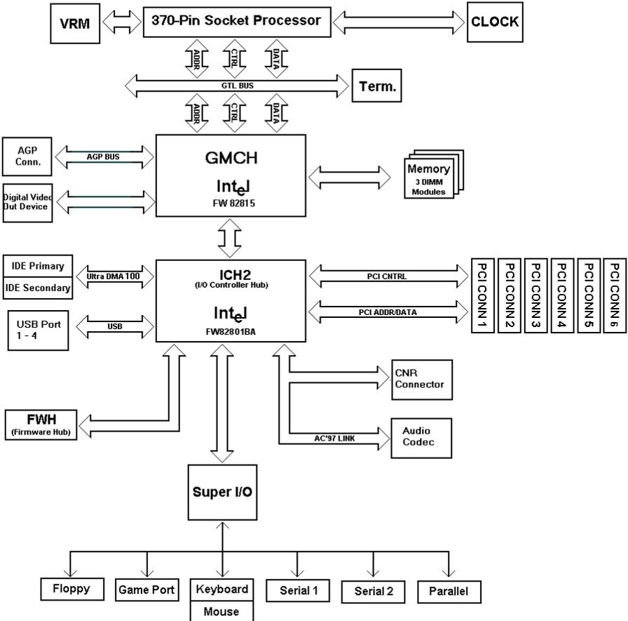
Abb. 1-2. System Block-Diagramm
