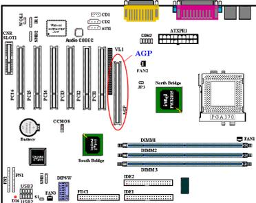
Diese Funktion wird zum Installieren eines AGP Inline Speichermodul benutzt (wahlfreies Modell RM-04). Dies ist ein wahlfreies Kennzeichen zu das an Bord VGA durch Erhöhen von der 3D Leistung verbessert.
