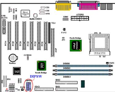
Mit diesem Schalter können Sie die Geschwindigkeit des Front Side Bus manuell einstellen.
