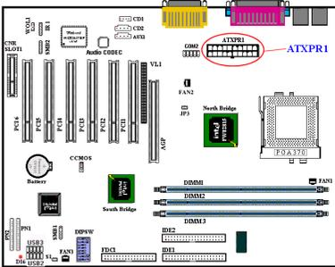
Den Anschluß von der Stromversorgung zum ATX-Anschluß hier befestigen. Dabei muß darauf geachtet werden, daß der Anschluß von der ATX-Stromversorgung fest ans Ende mit dem ATX-Anschluß gedrückt werden muß, um eine gute Verbindung sicherzustellen.
