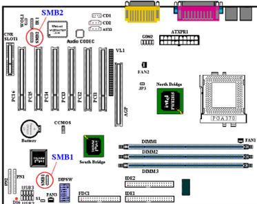
Dieser Anschluß ist für den Systemmanagementbus (SMBus) reserviert. Der SMBus ist eine besondere Anwendung eines I<sup>2</sup>C-Busses. I<sup>2</sup>C ist ein Multi-Masterbus, was bedeutet, daß mehrere Chips an denselben Bus angeschlossen werden können, wobei jeder als Master bei der Initiierung von Datentransfers dienen kann. Wenn mehr als ein Master gleichzeitig versuchen, den Bus zu steuern, bestimmt ein Entscheidungsvorgang, welcher Master Priorität bekommt.
