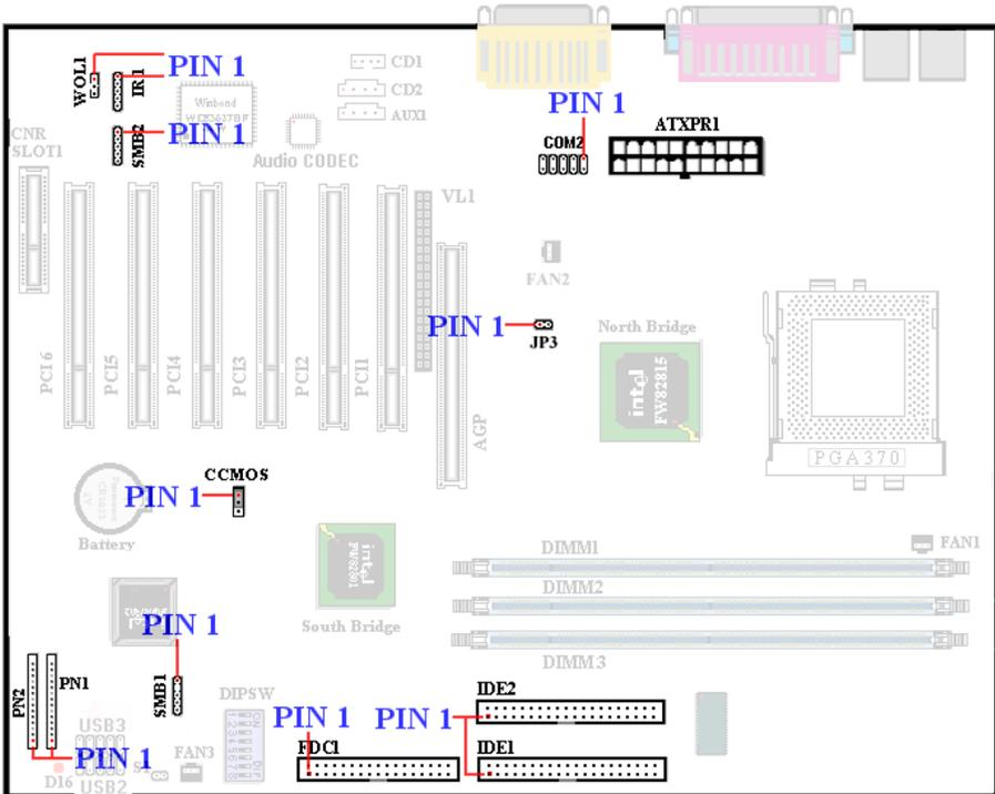
Abb. 2-5. Die Anschlüsse und Headers des SE6
