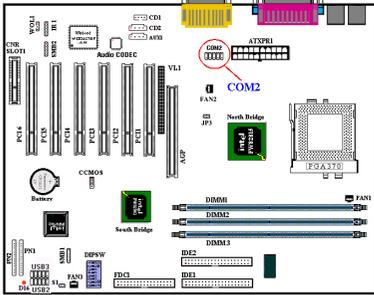
Sie können eine zusätzliche COM2-Schnittstelle an die Rückseite anschließen, indem Sie das dem Motherboard beigelegte Erweiterungskabel verwenden. Bitte richten Sie die rote Leitung des Kabels mit Pin 1 des COM2-Headers aus.
