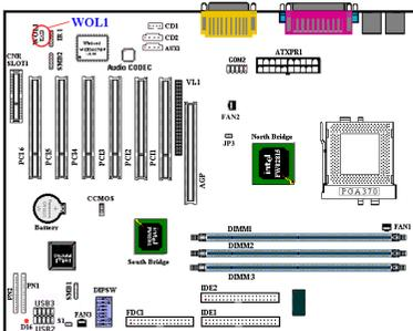
Falls Sie über eine Netzwerkkarte verfügen, durch welche dieses Merkmal unterstützt wird, kann das spezifische Kabel von der Netzwerkkarte an diesen Header angeschlossen werden. Durch dieses Merkmal können Sie Ihren PC mit Fernsteuerung über ein lokales Netz (LAN) aufwecken. Zum Steuern des Aufweckvorgangs kann ein spezifisches Hilfsprogramm erforderlich sein, z.B. das Intel® LDCM®-Hilfsprogramm oder andere ähnliche Hilfsprogramme.
