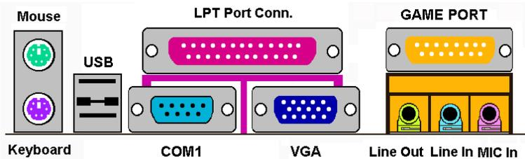
**Abb. 2-9. Anschlüsse auf der Rückseite des SE6**
