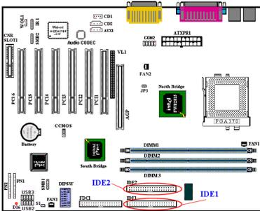
Ein Flachkabel eines IDE-Festplattenlaufwerks enthält 40 Drähte und ist mit zwei Anschlußsteckern versehen, um zwei IDE-Festplattenlaufwerke miteinander verbinden zu können. Nach dem Anschließen eines Endes an IDE1 (oder IDE2) verbinden Sie die beiden Anschlüsse am anderen Ende mit den IDE-Festplattenlaufwerken (oder CD-ROM-Laufwerk, LS-120 usw.). Wiederum sollte der Anschluss des längeren Kabels an den Anschluss des Motherboards angeschlossen werden.
