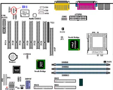
Für die Stiften von 1 bis 5 ist eine spezifische Lage gegeben. Den Anschluß vom IR-KIT oder IR-Gerät an den IR-Header befestigen. Diese Hauptplatine unterstützt Standard-IR-Übertragungsraten.
