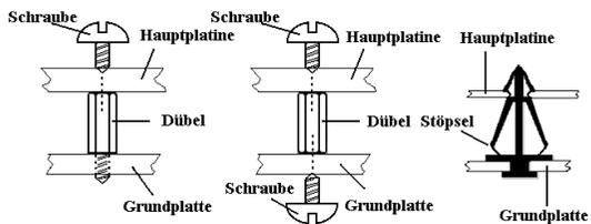
Abbildung 2-2. Befestigungsarten für die Hauptplatine
