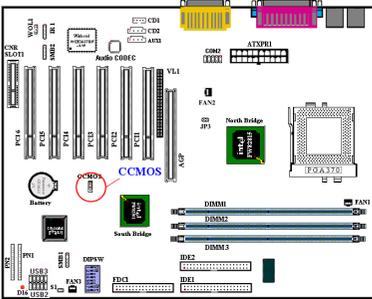
Steckbrücke CCMOS zur Entladung des CMOS-Speichers. Beim Installieren der Hauptplatine darauf achten, daß diese Steckbrücke für den Normalbetrieb eingestellt ist (Stift 1 und 2 müssen kurzgeschlossen sein). Siehe Abbildung 2-6.
