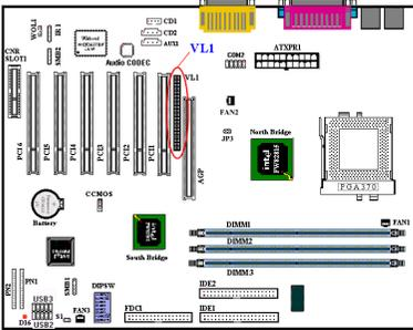
Dieser Anschluß kann eine Zusatzkarte aufnehmen, durch die VGA-Ausgabe über den TV-Ausgang oder den Flachbildschirm ermöglicht wird.
