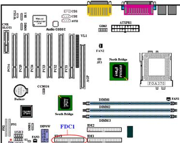
Dieser 34polige Anschlußstecker wird als “Floppylaufwerks-Anschlußstecker” bezeichnet. Damit kann ein 360K, 5,25”, 1,2M, 5,25”, 720K, 3,5”, 1,44M, 3,5” oder 2,88M, 3,5”-Floppylaufwerk, und sogar ein 3-Modus-Floppylaufwerk (ein 3-1/2-Zoll-Laufwerk, das in japanischen PC-Systemen benutzt wird) angeschlossen werden.
