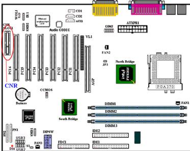
Diese Schnittstelle wird für eine optionale CNR-Schnittstelle bereitgehalten, die grundlegende Kosten im „Connected PC“ reduziert. Ebenso erweitert die CNR-Schnittstelle spezifisch-eingeschränkte Funktionsbereiche heutiger Audio-, Modem- und LAN-Systemen.
