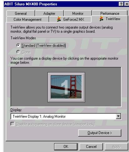
19. На этой закладке вы можете выбрать режим подключения одного видеоадаптера к двум разным устройствам вывода (аналоговый монитор, ЖК монитор или ТВ).
