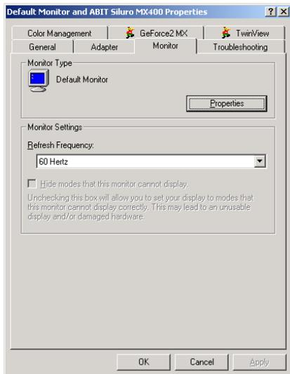
6. Выберите частоту обновления монитора. Нажмите “Свойства” (“Properties”) для подробной информации о мониторе.
