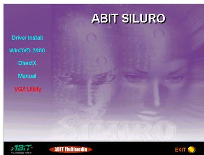
1. Вставьте инсталляционный диск в привод CD-ROM. Нажмите “VGA Utility”.
