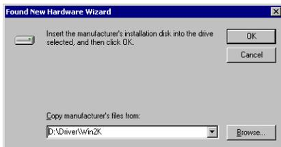
4. Вставьте инсталляционный диск в привод CD-ROM. Нажмите кнопку “Обзор” (“**B**rowse...”) для определения местонахождения драйвера или укажите путь к нему в текстовом окне. Нажмите “OK”.
