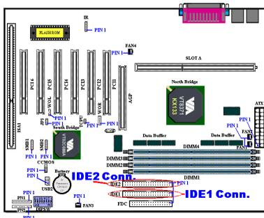
Une nappe pour disques durs IDE est composée de 40 câbles et fournit la connectique nécessaire aux branchements de deux disques durs IDE. Après avoir connecté un bout de votre nappe sur l'emplacement IDE1 (ou IDE2), connectez les deux autres connecteurs à votre (vos) disque dur (ou CD-ROM, LS-120, etc....)
