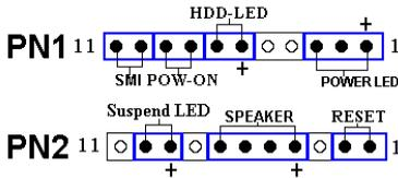
**Figure 2-7. définitions des pins du PN1 et PN2**
