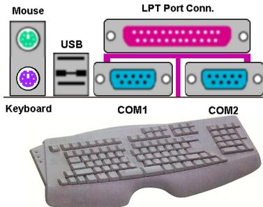
Connectez ici le connecteur DIN 6-pins de votre clavier PS/2. Si vous possédez déjà un clavier AT, vous pouvez utiliser un adaptateur AT vers ATX pour utiliser votre ancien clavier sur la KA7/KA7-100.
