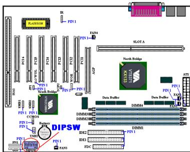
Ces switches vous permettent de manuellement sélectionner la fréquence externe. Pour les détails des différents paramétrages possibles, veuillez vous référer au tableau ci-dessous.
