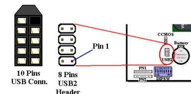
se peut qu'il vous soit fourni un connecteur USB utilisant 10 broches. Veuillez dans ce cas vous référer au diagramme à gauche pour installer ce type de connecteur.
