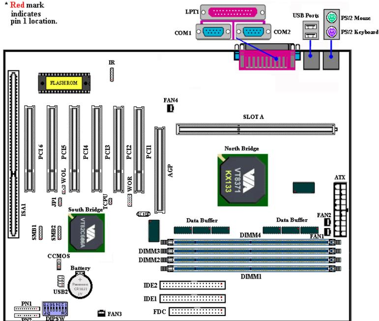
Figure 1-1. emplacements des composants sur la KA7
