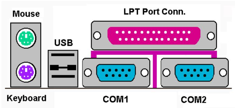
Figure 2-11. Disposition des connecteurs arrière de la KA7/KA7-100
