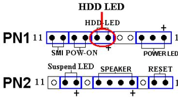
Connectez ici le câble de la diode disque dur de votre boîtier (2 fils, généralement rouge et noir, le rouge est le +). Si le sens du branchement est faux, la diode ne s'allumera pas correctement en cas d'activité du disque dur.
