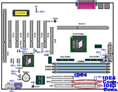
Le chipset HighPoint HPT370 intégré à la KA7-100 vous permet de supporter les futures spécifications ATA. Elle fournit deux canaux IDE (IDE3, IDE4) qui supporteront également les futures spécifications ATA et qui vous permettront de connecter quatre périphériques IDE additionnels à votre système.
