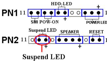
Insérez le câble 2 fils SUSPEND-LED de votre boîtier (si vous en avez un) sur cette broche. Installé dans le mauvais sens, la diode ne s'allumera pas correctement.
