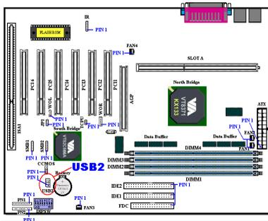
Ce connecteur est pour connecter des ports USB supplémentaires. Vous pouvez utiliser le câble d'expansion USB spécial (optionnel). Il fournit deux plugs USB supplémentaires. Ces plugs USB peuvent être fixés sur le panneau arrière de votre boîtier.
