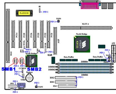
Ces connecteurs sont réservés pour le bus de gestion du système (SMBus). Le SMBus est une implémentation spécifique du bus I<sup>2</sup>C. Le bus I<sup>2</sup>C est un bus multi-master, ce qui signifie que plusieurs chips peuvent y être connectés et que chacun d'entre eux peuvent agir en tant que maître du bus en initiant un transfert de données. Si plus d'un maître essaie de contrôler simultanément le bus, une procédure d'arbitration décide alors
