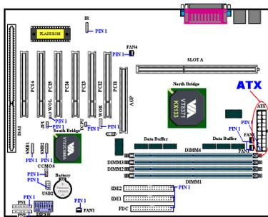
Branchez le connecteur d'alimentation de votre alimentation ATX ici. Des détrompeurs sont présents pour vous guider dans le sens de connexion. Enfoncez fermement votre connecteur jusqu'au bout dans l'ATX.
