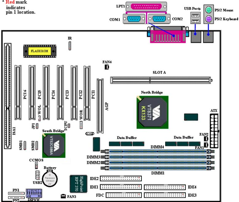
Figure 1-2. emplacements des composants sur la KA7-100
