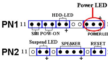
Il y a une orientation spécifique à respecter. Branchez le câble du Power LED aux pins 1-3 du PN1. Assurez vous que les bons câbles vont sur les bons connecteurs. Si vous branchez le fil du Power LED dans le mauvais sens, la diode Power de votre boîtier ne s'allumera pas. (Note: Généralement, le câble du Power LED est
