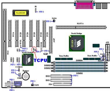
Le connecteur TCPU est à votre disposition pour y connecter une sonde thermique pour détecter la température du CPU. Vous pouvez y connecter l'extrémité du câble à deux fils de votre sonde thermique (fournie avec votre carte mère) sur le connecteur TCPU et ensuite, coller l'autre extrémité sur le dissipateur de chaleur du CPU. D'une façon générale, la sonde doit être le plus proche possible de la puce même du CPU et
