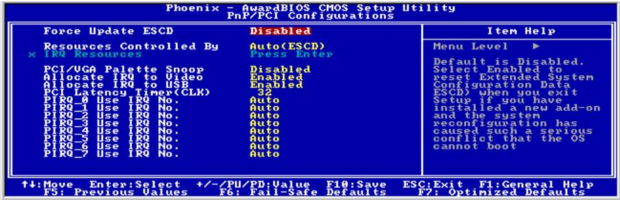
Abb. 3-9. PnP/PCI-Konfigurations-Setup
