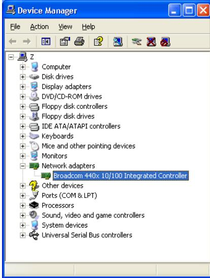
1. Nach beendeter Treiberinstallation prüfen Sie [Netzwerkadapter] im [Gerätmanager]. Sie werden sehen, dass der [Broadcom 440x 10/100 Integrated Controller] erfolgreich installiert wurde.
