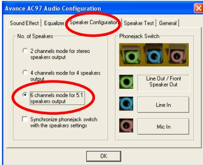
5. Wählen Sie in diesem Lautsprecher-Konfigurationsregister [6-Kanal-Modus für 5.1-Lautsprecherausgabe], um das 6-Kanal-Audiosystem zu aktivieren.
