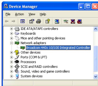
1. ドライバのインストールが終了したら、[デバイス マネージャ]で[ネットワークアダプタ]にチェックマークを入れてください。[Broadcom 440x 10/100 Integrated Controller]が正常にインストールされていると、表示されます。
