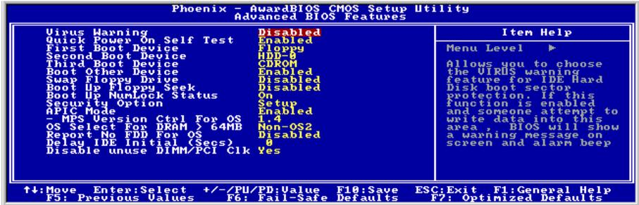
図 3-5. Advanced BIOS Features Setup スクリーン
