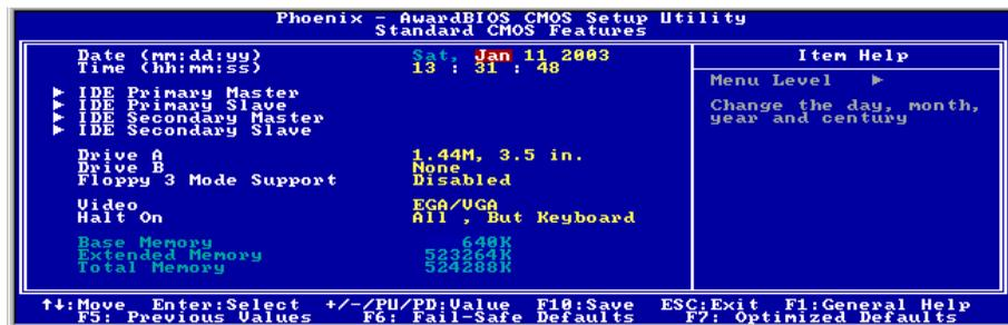
図 3-3. Standard CMOS Setup スクリーン
